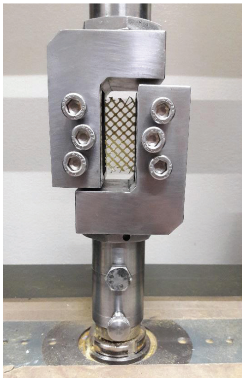
Rys. 5. Próbkę umocowaną w uchwytach maszyny Zwick/Roell Fig. 5. View of sample fixed in a Zwick/Roell testing machine
