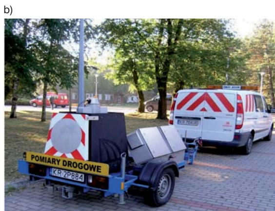
Fot. 1. a) Geofony pomiarowe oraz płyta naciskowa; b) zestaw pomiarowy FWD
