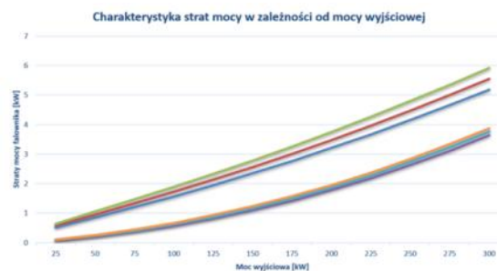
Rys. 4. Charakterystyka strat mocy falownika STS-202 w zależności od mocy wyjściowej
