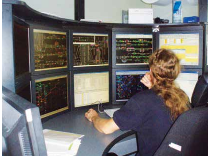
Stanowisko dyżurnego ruchu w jednym z centrów sterowania ruchem kolejowym ÓBB
