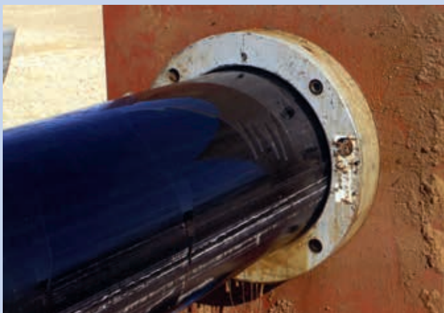
Ryc. 5. Urządzenie służące do redukcji średnicy przewodów polietylenowych [1, s. 46]
