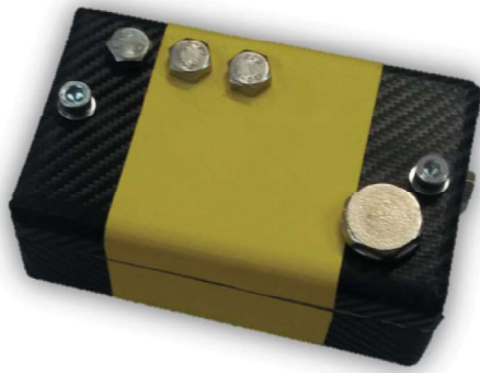
Rys. 6. Moduł (PD) do pomiaru drgań i orientacji kadłuba maszyny urabiającej
