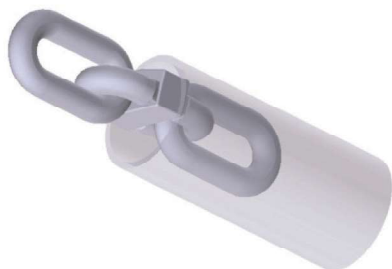
Rys. 5. Przykładowe ogniwa pomiarowe (PF) wykonane dla łańcucha ogniwowego górniczego wielkości 42x137: a) odcinek trzy ogniwowy z układem pomiarowym, b) położenie ogniwa pomiarowego poziomego w gnieździe koła napędowego, c) schemat przedstawiający współpracę odcinka pomiarowego łańcucha pociągowego z prowadzeniem rurowym maszyny urabiającej
