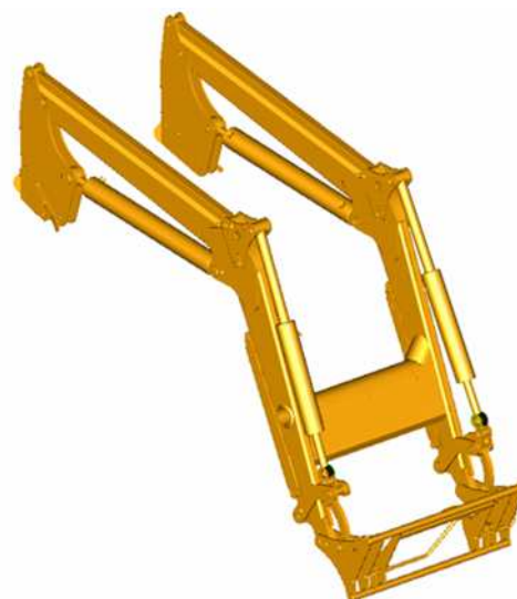
Source: own study / Źródło: opracowanie własne Fig. 1. 3D model of front loader Rys. 1. Model 3D ładowacza czołowego
