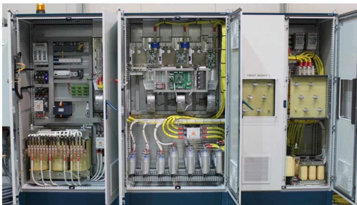
Rys. 2. Stanowisko badawcze do testowania filtrów stosowanych w napędach
