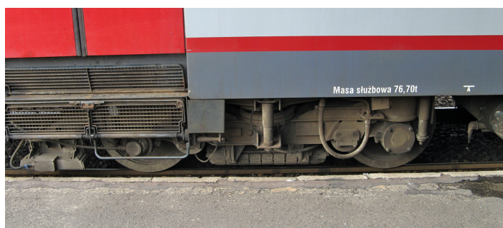
Wózek napędny i toczny w wagonie silnikowym serii DH2
