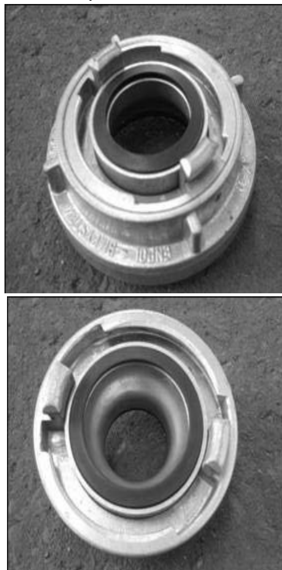
Ryc. 5. Przełącznik Fig. 5. Hose adapter
