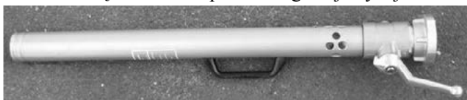
Ryc. 15. Prądownica pianowa Fig. 15. Foam making nozzle
