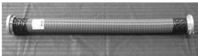
Ryc. 3. Pożarniczy wąż ssawny z PCV Fig. 3. Suctions fire PCV hose
