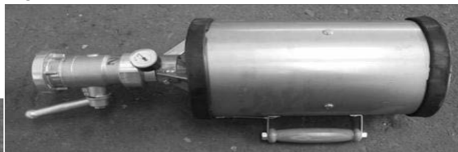
Ryc. 16. Wytwornica pianowa Fig. 16. Foam generator
