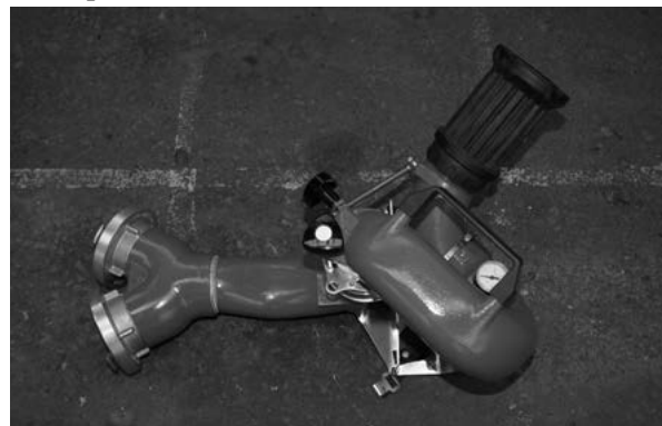
Ryc. 19. Działka wodno-pianowe z prądownicą wodną Fig. 19. Water-foam monitor with water nozzles
