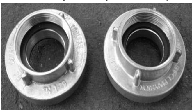
Ryc. 6. Nasady: mosiężna (po lewej), aluminiowa (po prawej) Fig. 6. Outlet couplings
