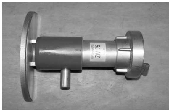
Ryc. 18. Urządzenie do wytwarzania zasłony wodnej Fig. 18. Device for producing water curtains
