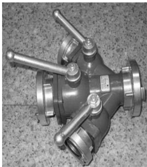
Ryc. 8. Rozdzielacz kulowy Fig. 8. Triple head distributors
