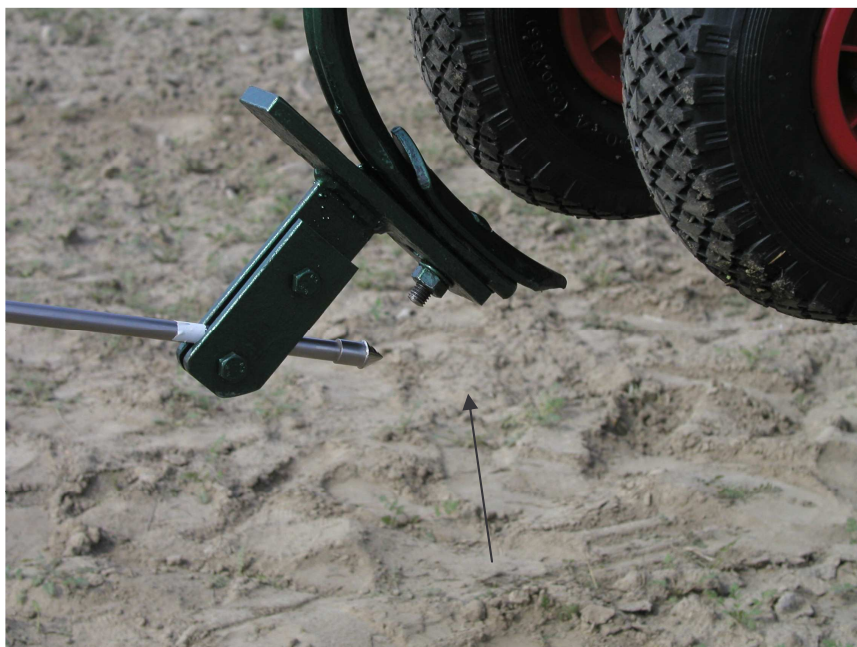
Rys. 2. Sonda z czujnikiem podczerwieni przygotowana do badań Fig. 2. The probe with infrared gauge prepared for measurements
