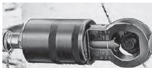
Rys.5. Usuwanie skorodowanej nakrętki z wykorzystaniem przecinaka hydraulicznego SPX [8]
