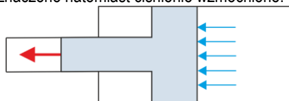
Rys.17. Zasada działania wzmacniacza ciśnienia
