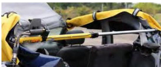
Rys.12. Zastosowanie rozpieracza kolumnowego [2]
