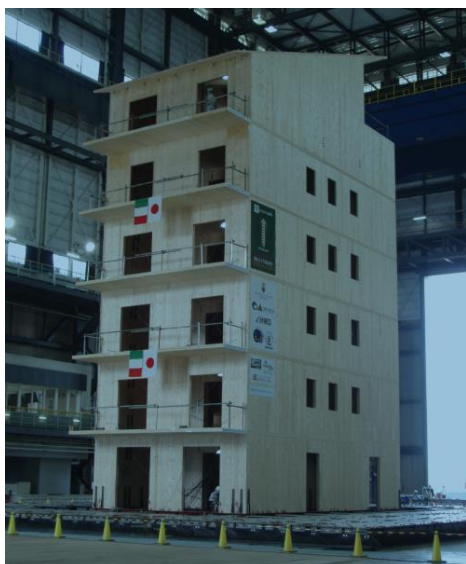
Rys. 12. Budynek testowy, projekt SOFIE (FPInnovations, 2011)
