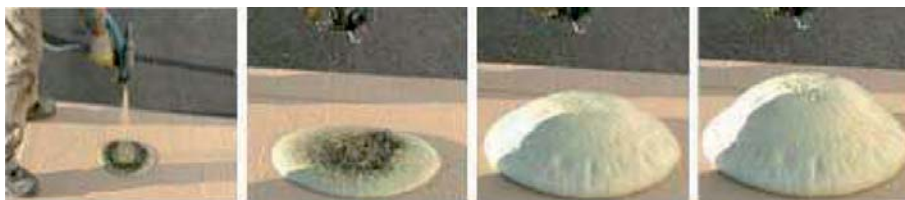
Fot. 4. Swobodne rozprężanie materiału geopolimerowego – kolejne etapy
