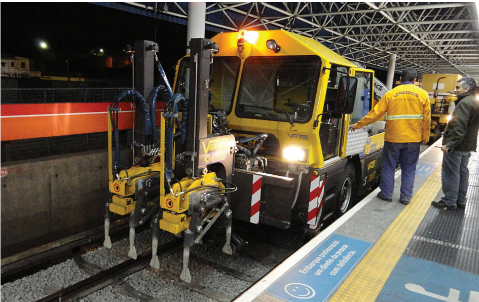
Rys. 8. Wielofunkcyjna maszyna kolejowo-drogowa wyposażona w urządzenie do podbijania podkładów [5]
