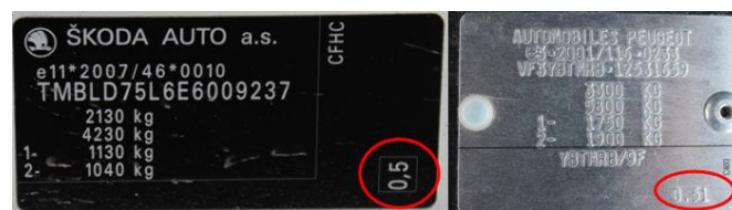
Rys. 3. Określenie na tabliczce znamionowej współczynnika pochłaniania światła.
