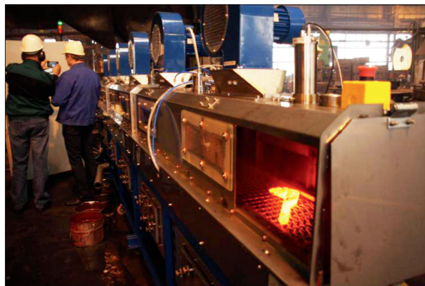
Rys. 1. Badawcze stanowisko przemysłowe do regulowanego chłodzenia odkuwek bezpośrednio po kuciu, wykonane w kuźni WOSTAL w ramach projektu TERMOTECH / NCBR-PBS2/B5/29/2013
