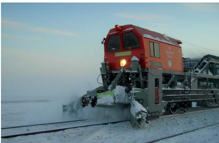
Kombajn do odśnieżania torów, mijanka nr 4 km linii Obskaja – Bowanienkowo (13.10.2007 r.) Fot. ze zbiorów autora
