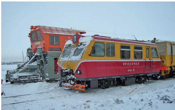
Wagon motorowy serii AC1A.2-521 oraz pług odśnieżny serii CM2M-1898 na stacji Obskaja (1.03.2009 r.) Fot. ze zbiorów autora
