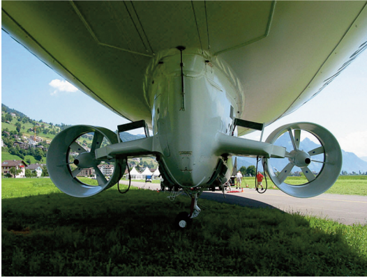
Rys. 2. Gondola sterowca Skyship 600, wyposażonego w napęd otunelowany [8]
