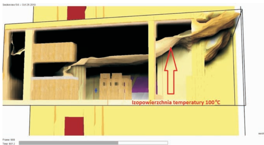
Rys. 3.3-i. Izopowierzchnia temperatury (100°C – żółta powierzchnia) w chwili wejścia strażaków do pomieszczenia
