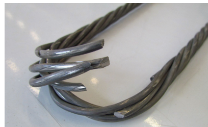
Rys. 5. Typowa postać zniszczenia liny
