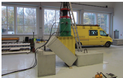
Rys. 8. Widok stanowiska do badań z obciążeniem przyłożonym pod kątem 45°
