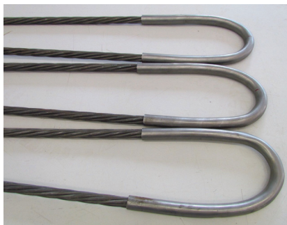
Rys. 3. Próbkę pojedynczych lin przygotowane do badań
