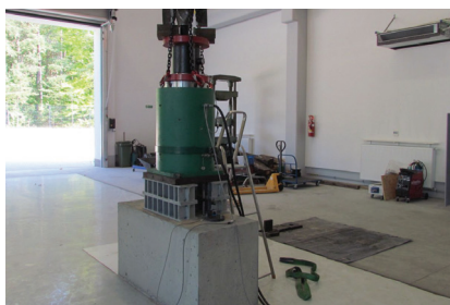
Rys. 7. Widok stanowiska do badań z obciążeniem przyłożonym pod kątem 0° do pionu
