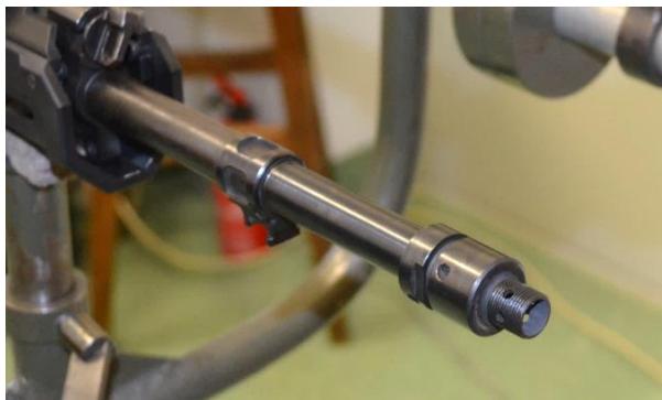
Fot. 4.1. Karabinek systemu MSBS-5,56 bez UW na stanowisku badawczym Photo 4.1. Carbine of MSBS-5.56 system without MD on the set-up
