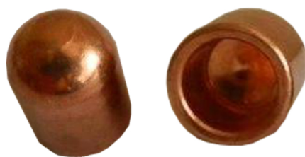
Rys. 4. Elektrody nasadkowe do zgrzewania punktowego z kompozytu Cu-Al 2 O 3 , wykonane metodą łączoną SPS-KOBO Fig. 4. Cu-Al 2 O 3 cap electrodes for spot welding made with combined SPS-KOBO method
