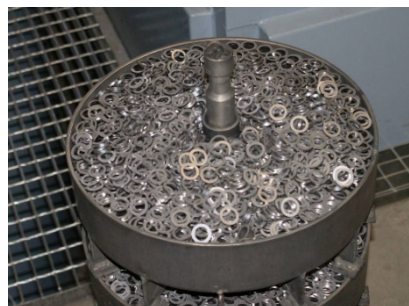
Rys. 10. Pierścienie ułożone w koszykach po spiekanii wstępnym Fig. 10. Rings arranged in baskets after presintering
