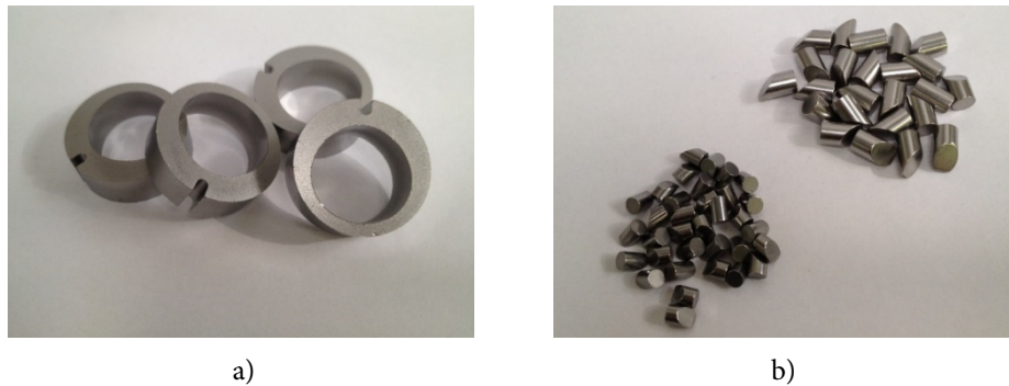
Rys. 8. Pierścienie krzywkowe (a) oraz klin (b) wykonane z proszku na bazie Fe konwencjonalnymi metodami metalurgii proszków Fig. 8. Cam rings (a) and wedges (b) made of Fe-based powder by conventional powder metallurgy methods
