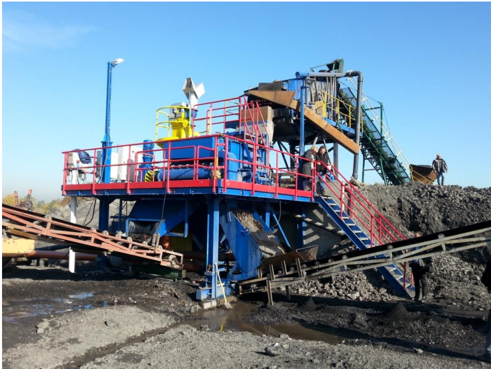
Rys. 2. Klasyfikator pulsacyjny K102 nr 1 zabudowany w instalacji do rekultywacji składowiska pokopalnianego Przechlebie [11]
