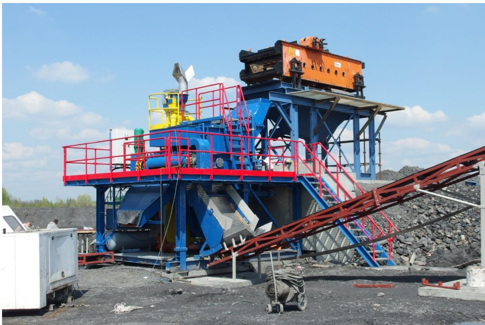
Rys. 3. Klasyfikator pulsacyjny K102 nr 2 zabudowany w instalacji do rekultywacji składowiska pokopalnianego [11]
