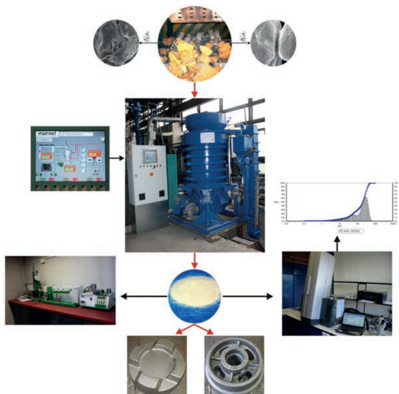
Rys. 4. Widok regeneratora prototypowego na stanowisku badawczym z symbolicznym zaznaczeniem realizowanych prób i analiz [18,20]
