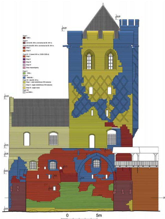
Ryc. 4. Wieża Klesza na Zamku Wysokim w Malborku. Elewacja wschodnia, rozwarstwienie chronologiczne (oprac. M. Prarat) Fig. 4. The Klesza Tower in the High Castle in Malbork. East elevation, chronological stratification (auth. M. Prarat)
