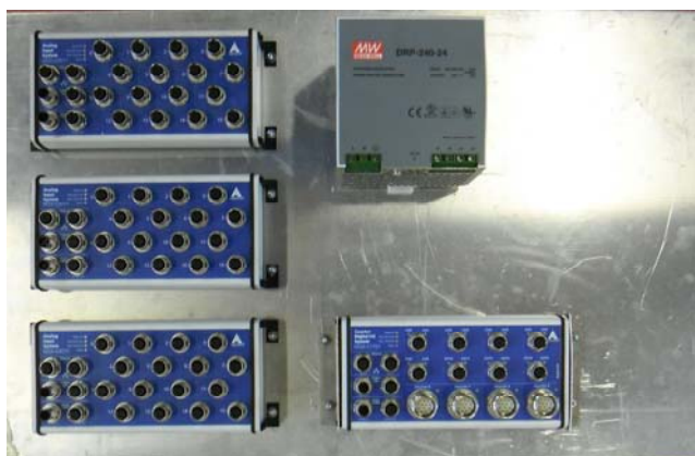
Fot. 1. Widok kart pomiarowych MSX-E3011 (po lewej) i MSX-E1701(po prawej); u góry widoczny zasilacz 24 VDC do zasilania kart (widok bez podłączonych kabli zasilających i transmisyjnych)
