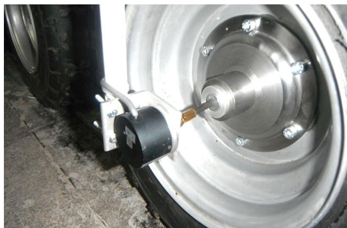
Fot. 2. Enkoder umieszczony na kole platformy
