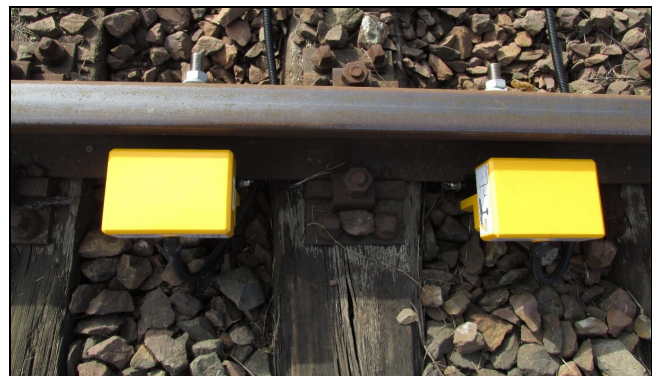
Rys. 6. Ogólny widok anten pomiarowych zamontowanych w torowisku
