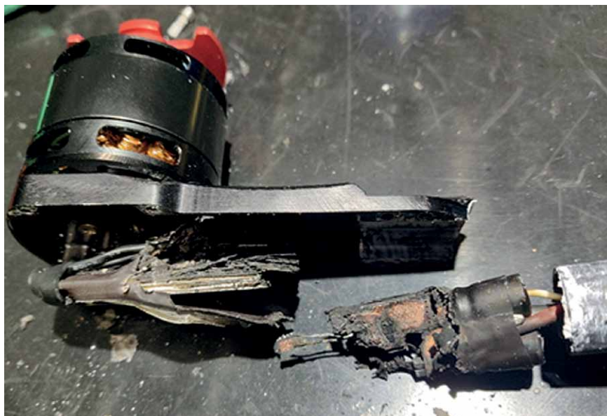
Rys. 10. Wpływ wyładowania ESD 25 kV na niezabezpieczony zespół napędowy BLDC (spalony regulator)
