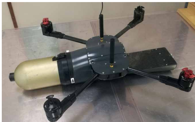
Rys. 2. Badany BSP wraz z czterema zespołami napędowymi BLDC bez śmigieł
