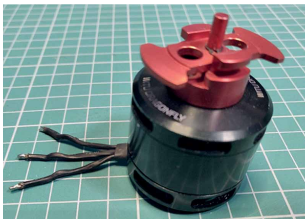
Rys. 3. Silnik BLDC zastosowany do napędu badanego BSP
