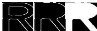
Rys. 5. Zestawienie operacji na znakach, kolejno od lewej: wykrycie krawędzi znaku, znak po odrzuceniu wnętrza i znak po wypełnieniu
