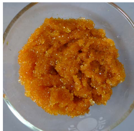
Ryc. 8. Żółty osad wytrącony z próbki M-32/2.
