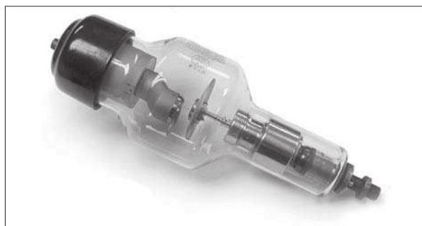
Fot. 4. Lampa z anodą wirującą RT-1-2 firmy General Electric [6]
