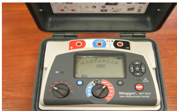
Rys. 1. Aparatura do pomiarów izolacji metodą prądu stałego stosowana w cementowni
