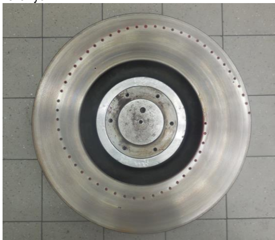
Rys. 6. Widok tarczy hamulcowej typu 590x110 z wykonanymi nawierceniami w kształcie spirali Archimedeasa
