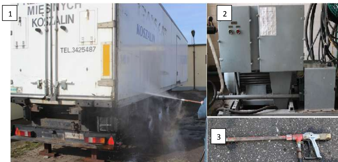
Rys. 8. Czyszczenie pulsacyjnym strumieniem wodnym naczepy (1) samochodu ciężarowego przy użyciu instalacji składającej się z hydromonitora (2) typu P30 i pistoletu (3) typu lanca (WOMA typu HP 750-2) wyposażonego w samowzbudną dyszę pulsacyjną
