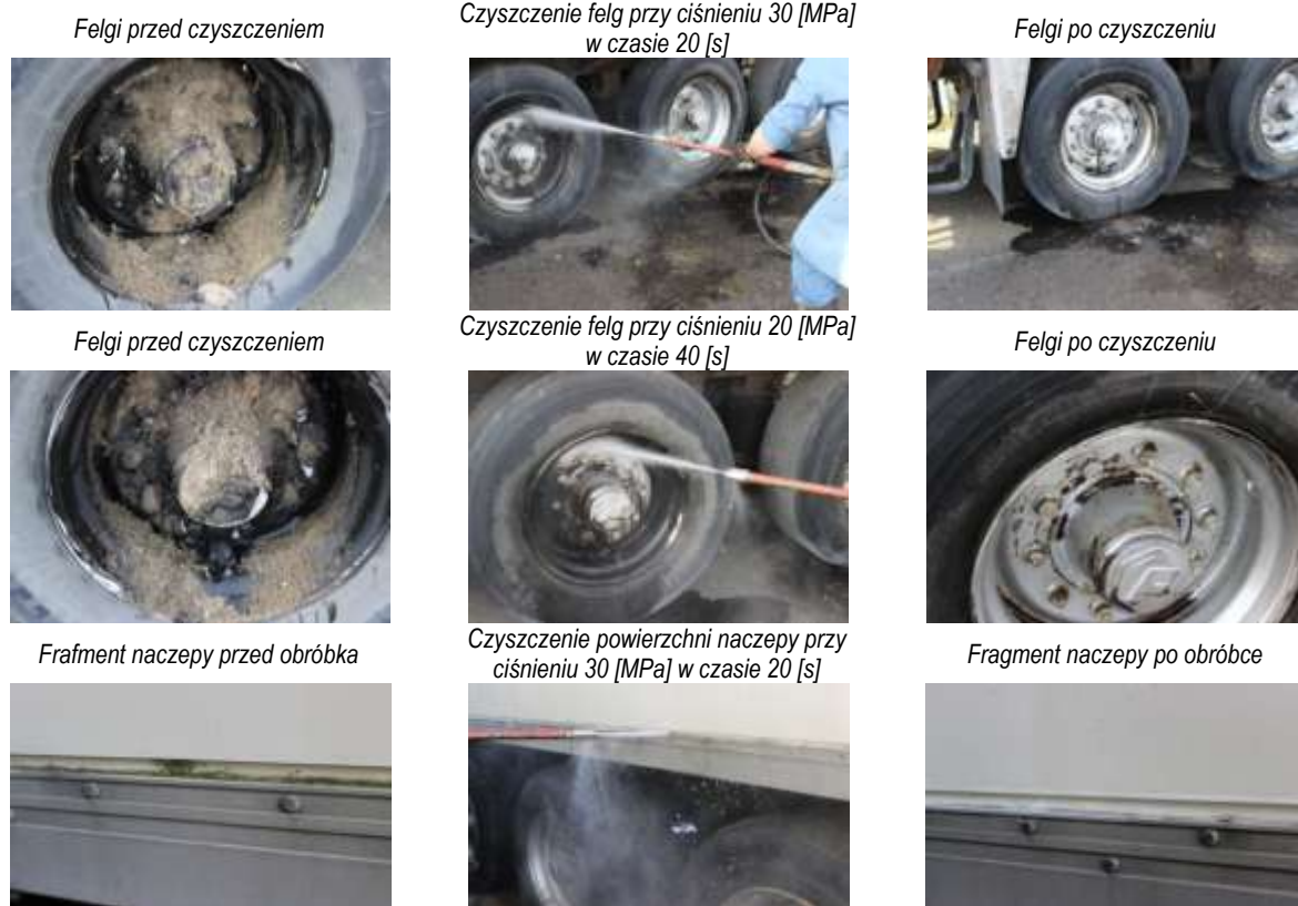
Rys. 9. Usuwanie zabrudzeń naczepy przy zastosowaniu pulsacyjnej strugi wodnej wytwarzanej w samowzbudnej dyszy pulsacyjnej
