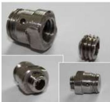
Rys. 3. Samowzбудna dysza pulsacyjna wykonana do badań laboratoryjnych
