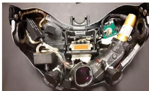
Rys. 2. Widok nakładki systemu nahałmowego JHMCS z sensorem pola magnetycznego w postaci układu modułowego [9]
