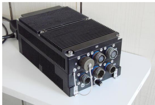
Rys. 6. Widok komputera graficznego z oprogramowaniem sterującym trybami zobrazowania nahlmowego systemu NSC-1 [8]
