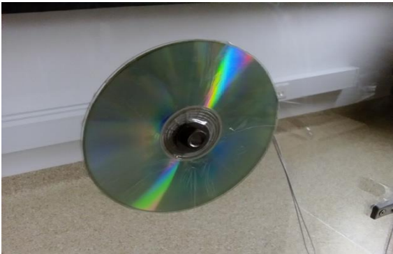
Rys. 12. Widok modelu fizycznego cewki płaskiej jednorodnej zbudowanego dla systemu NSC-1 [9]
