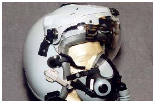
Rys. 1. Widok hełmu pilota samolotu F-16 z zamontowaną nakładką nahałmowego systemu celowniczego JHMCS [9]
