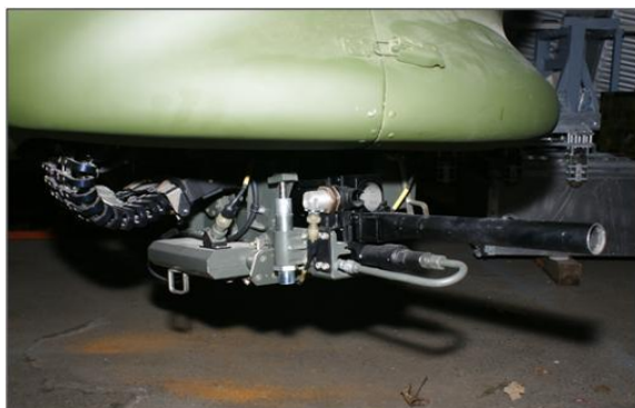
Rys. 5. Widok ruchomego stanowiska WKM-B śmigłowca W-3PL sterowanego przez nahlmowy system celowniczy NSC-1 [8]
