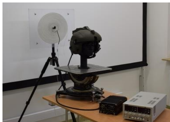
Rys. 24. Widok układu pomiarowego z modelem cewki płaskiej dzielonej (3 pierścienie) zbudowanego dla systemu NSC-1 [9]
