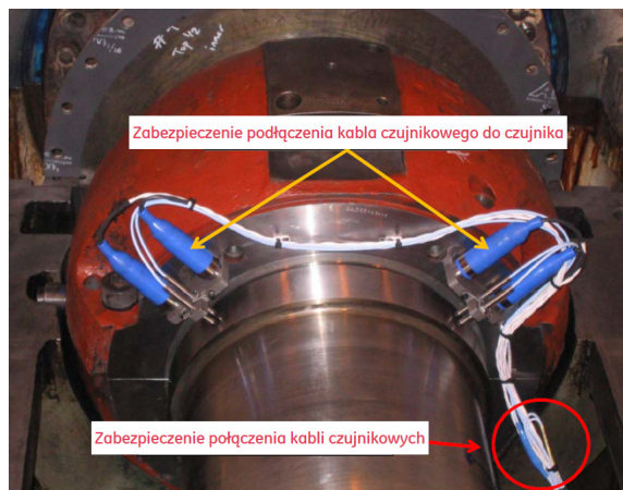
Rys. 10. Wzorcowy sposób instalacji czujników drgań względnych oraz pomiarów drgań sejsmicznych dla turbozespołu; widoczne są czujniki podstawowe oraz redundantne mocowane bezpośrednio do łożysk.
