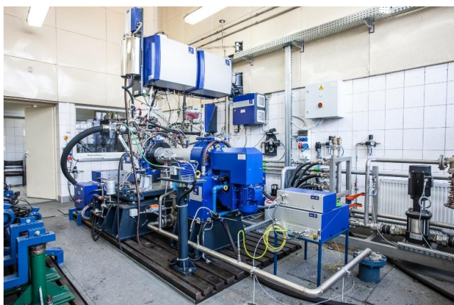
Rys. 2. Widok stanowiska badawczego AVL.
