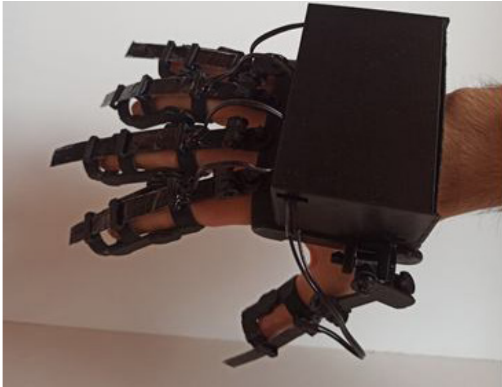
Fig. 5. Exo-glove on the hand Rys. 5. Rękawica założona na dłoń Source: Own work
