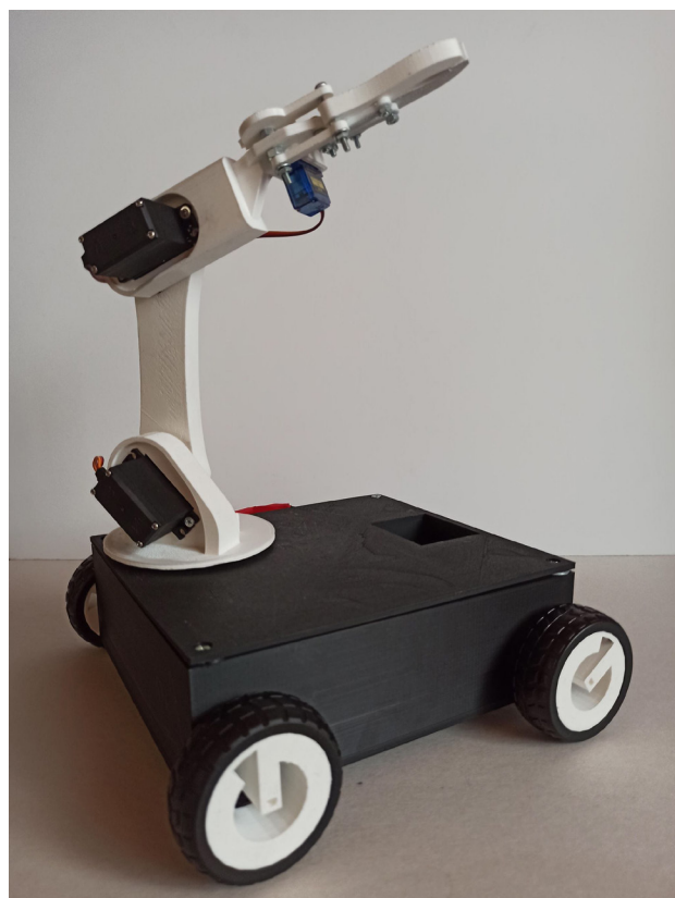
Fig. 9. Completed robot with a closed gripper jaw Rys. 9. Gotowy robot z zamkniętymi szczękami chwytaka Source: Own work
