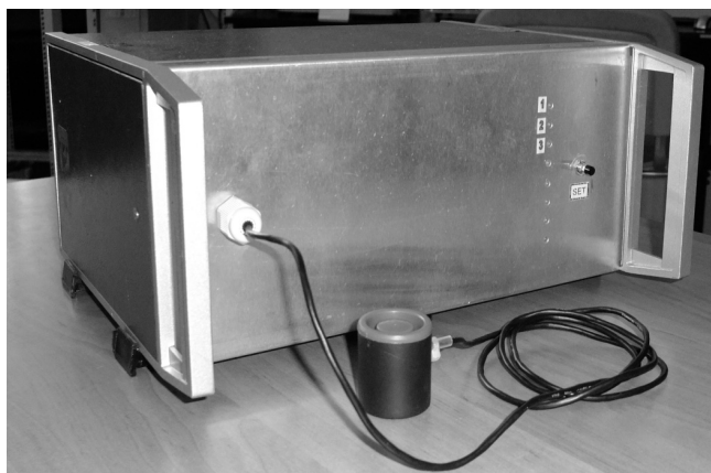
Rys. 2. Generator z mikroprocesorowym symulatorem sygnału z silnika krokowego zegara elektronicznego Fig. 2. Generator with the microprocessor signal simulator of the electronic watch stepper motor
