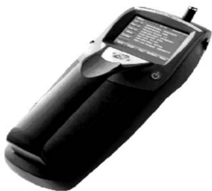
Rys. 5. Pyłomierz zastosowany do badań Źródło: www.wios.warszawa.pl/download/1/106/1/pylyzaw2008.pdf z dn. 26.03.2014 r.
