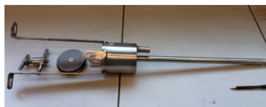
Rys. 3. Komora do okresowych badań mielenia w młynie elektromagnetycznym
