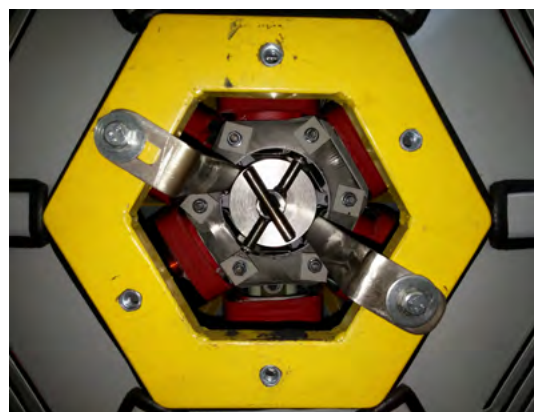
Rys. 4. Umieszczenie komory w młynie elektromagnetycznym
