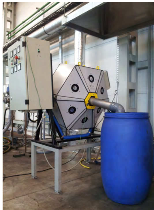
Rys. 2. Stanowisko badawcze z młynem elektromagnetycznym WZB. MAGØ100
