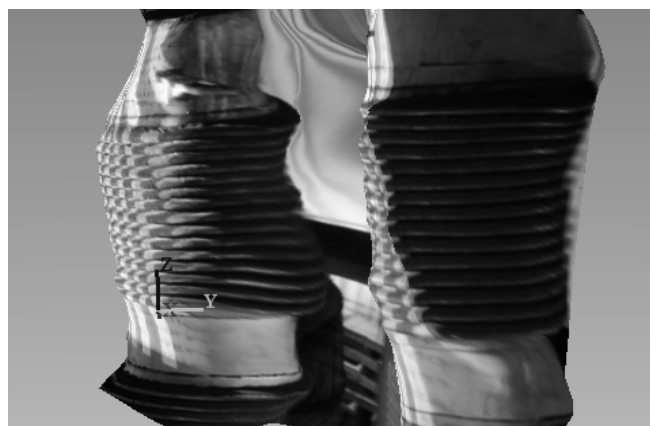
Rys. 5. Modele kompensatorów z wyświetlonym wzorem paskowym
