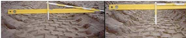
Fig. 6. Adjustment of the working depth Rys. 6. Dostosowanie głębokości roboczej
