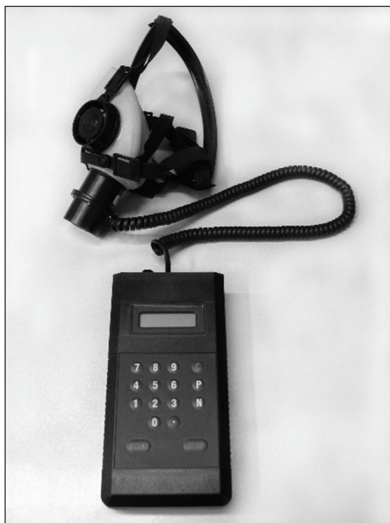
Rys. 5. Miernik MWE-1 zbudowany z trzech podstawowych podzespołów: półmaska twarzowa (dostępna w dwóch rozmiarach), turbina – przepływomierz, miernik. Źródło : http://arkadia.kalisz.pl/wp-content/uploads/2016/03/2.png
