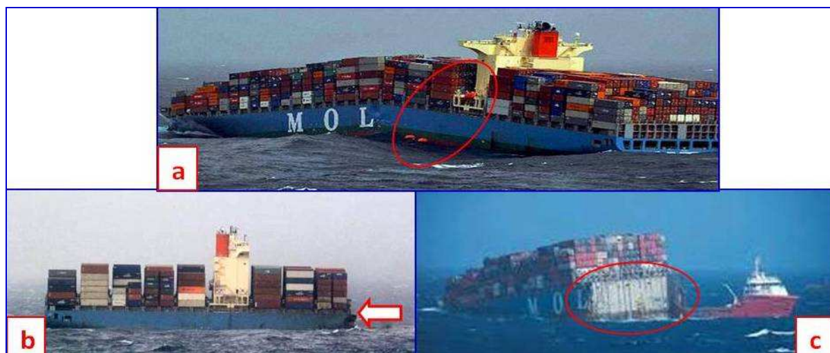
Rys. 4. Kontenerowiec – a) pęknięcie kadłuba na skutek zmęczenia materiału, elipsą zaznaczone środki ratunkowe, b) część rufowa utrzymująca przez potrzebny do ewakuacji załogi czas stateczność, strzałka wskazuje miejsce przełamania , c) podwójne poszycie kadłuba oraz grodzie pozwoliły na utrzymanie dziobowej części pływalności, elipsą zaznaczona poprzeczna gródź wodoszczelna [3]
