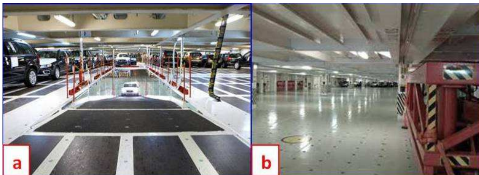
Rys. 7. Statek Ro-Ro – a) pokłady o dużej powierzchni, bez przegród poprzecznych, rampy stałe lub podnoszone, b) na pokładzie widoczne miejsca do mocowania ładunku [2]
