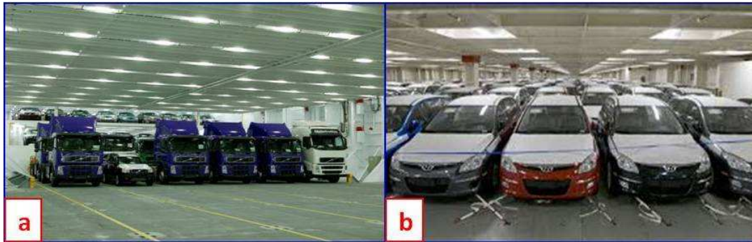
Rys. 8. Statek Ro-Ro – a) pokład ładunkowy o dużej przestrzeni z ładunkiem pojazdów o różnych wymiarach, masach, trudnym do wyznaczenia środka ciężkości, b) pokład ładunkowy o dużej przestrzeni z samochodami osobowymi o niestabilnym podwoziu, zamocowanych pasami [2] Źródło: [2]
