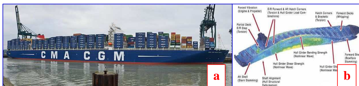
Rys. 3. Kontenerowiec – a) długi kadłub bez pokładu podczas pracy na fali jest podatny na odkształcenia, b) w każdym stanie eksploatacyjnym prowadzone są obliczenia wytrzymałościowe [2]
