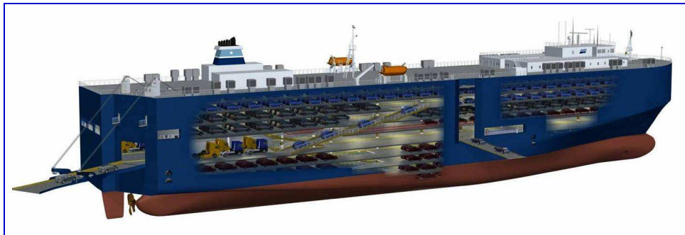
Rys. 6. Statek Ro-Ro – a) Statek przystosowany do załadunku i wyładunku w systemie ro-ro tj. przy użyciu statkowych wrót/ramp, za pomocą środków transportu kołowego [2]
