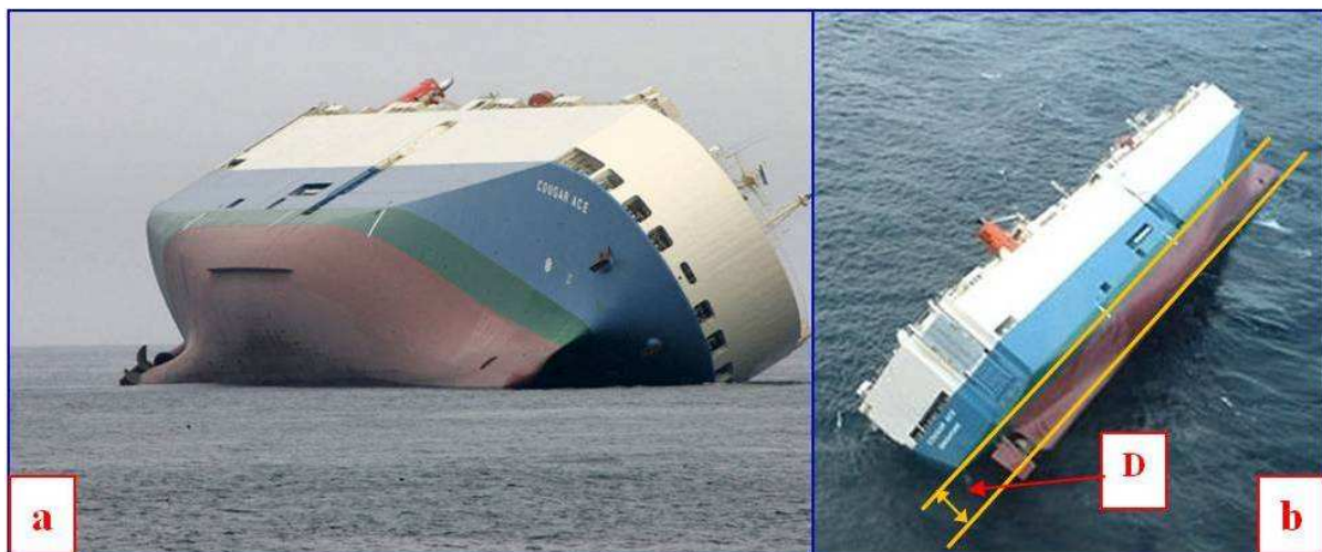
Rys. 9. Statek Ro-Ro – a) na szczęście statek zachował szczelność, stracił stateczność b) literą „D” zaznaczono zanurzenie, które jak widać jest ok. 2 razy mniejsze od wolnej burty (wynosi ok.12 m), co przy zalanych niewłaściwie balastach spowodowało utratę stateczności [4] Źródło: [4]
