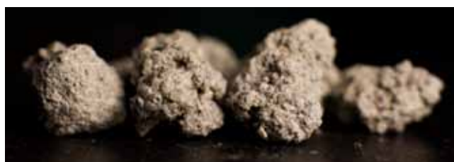
Rys. 3. Wygląd granulatu pozyskanego ze świeżej zaprawy cementowej (ziarna 4 mm)
