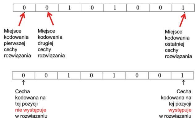
Rys. 15. Przykładowa budowa chromosomu binarnego używanego w algorytmach genetycznych
