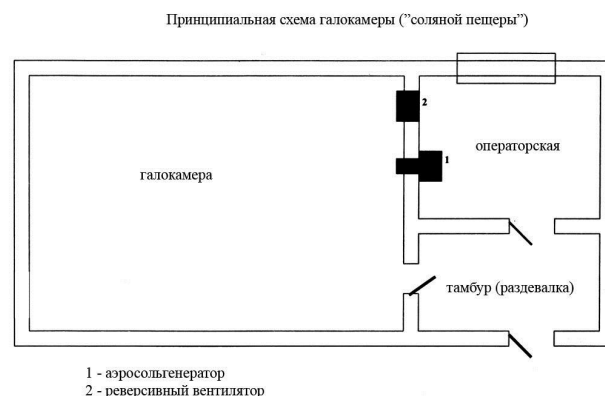
Рис.1. Принципиальная схема галокамеры («соляной пещеры»). Источник: разработка автора Rys.1. Schemat halokompleksu („grota solna”). Źródło: oprac. własne
