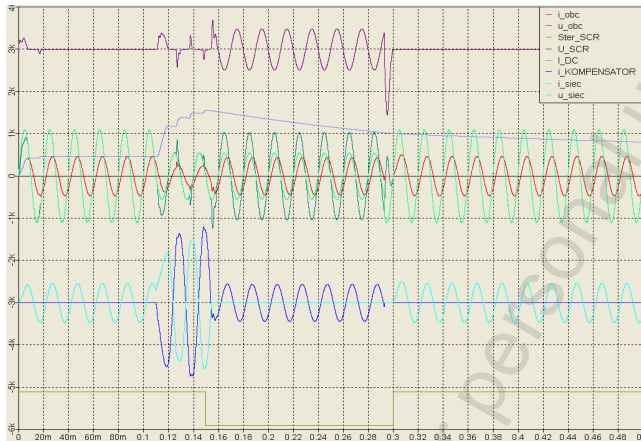
Rys. 7. Przebiegi w układzie łącznika z rezystancjami (obc. RLC), w stanach: przewodzenia, nieprzewodzenia (kompensacja zapadu) i przewodzenia. Powiększone 100x rezystancje przewodzenia tyrystorów grupy katodowej ( R_{p1} = R_{p2} = 0.1\Omega )
